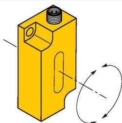
Réglage de la plage de mesure via l'adaptateur d'apprentissage TX1-Q20L60
