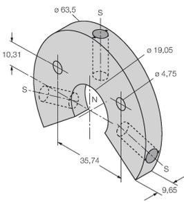
Transmetteur de position annulaire avec fente, peut être utilisé avec un clip de fixation RB-R10 en cas de montage externe, matériau : Aluminium
