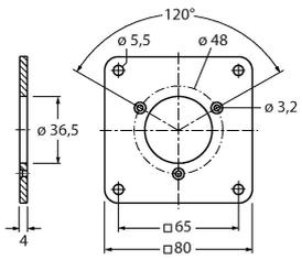
adaptateur à bride carré en aluminium pour codeur à arbre sortant avec bride standard; longueur 80 mm; épaisseur 4 mm
