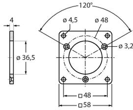
adaptateur à bride carré en aluminium pour codeur à arbre sortant avec bride standard; longueur 58 mm; épaisseur 4 mm
