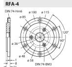
bride Euro - adaptateur à bride en aluminium pour codeur à arbre sortant, Ø 115 mm, diamètre primitif de référence 100 mm; pour la conversion de la bride standard 58 mm en bride Euro
