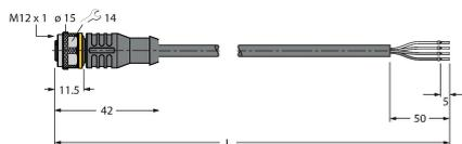
Câble de raccordement, connecteur femelle M12, droit, 4 broches, longueur de câble : 2 m, matériau de la gaine : PVC, noir ; homologation cULus
