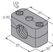
Bride de fixation pour détecteurs à tube fileté et lisse ; matériau : polypropylène
