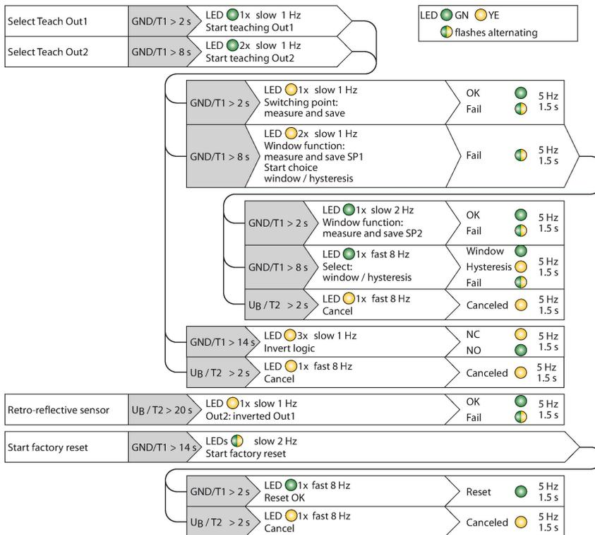
fenêtre ou le fonctionnement par réflexion sur une cible fixe peuvent être apprises. Veuillez vous référer au manuel d'utilisation pour plus d'informations. Ci-après on décrit le fonctionnement de fenêtre en apprenant deux limites. Ceux-ci forment la fenêtre de commutation et peuvent se trouver arbitrairement dans la plage de détection.
