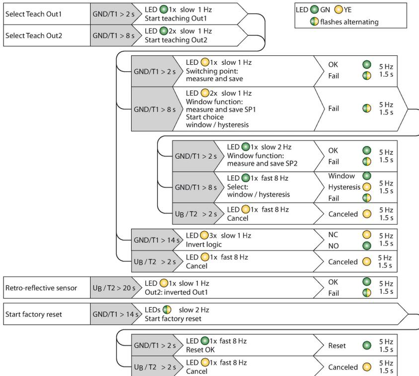
le fonctionnement de fenêtre en apprenant deux limites. Ceux-ci forment la fenêtre de commutation et peuvent se trouver arbitrairement dans la plage de détection.
