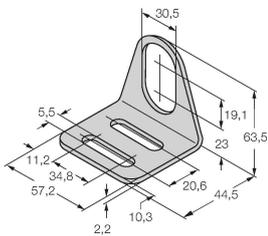
Équerre de fixation pour détecteurs à tube fileté ; matériau : acier inoxydable A2 1.4301 (AISI 304)
