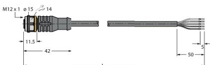
Câble de raccordement, connecteur femelle M12, droit, 5 broches, longueur de câble : 2 m, matériau de la gaine : PVC, noir ; homologation cULus
