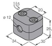
Bride de fixation pour détecteurs à tube fileté et lisse ; matériau : polypropylène
