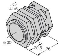
bride de fixation pour montage rapide avec butée fixe; matériau: Laiton chromé. Filetage externe M36 x 1,5
