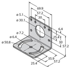
bride de fixation, à angle droit, acier inoxydable, pour les détecteurs avec filetage 30 mm, trous de forage larges pour un alignement précis
