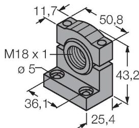
bride de fixation, noir PBT, pour les détecteurs à filetage 18 mm, orientable
