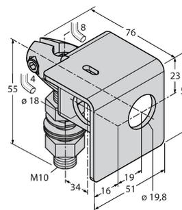
équerre de montage, matériau VA 1.4401, pour filetage 18 mm, filetage M10 x 1,5
