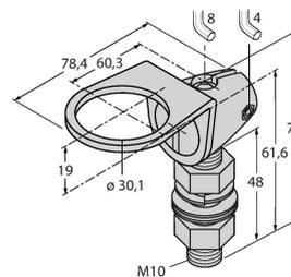
équerre de montage, acier inoxydable, pour filetage 30 mm, filetage M10 x 1,5
