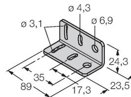
équerre de montage, acier inoxydable, pour le format MINI-BEAM NAMUR
