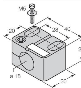
Bride de fixation pour détecteurs à tube fileté, sans butée fixe ; matériau : PA6
