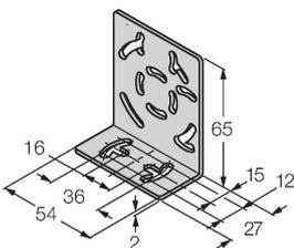
équerre de montage, acier inoxydable, pour les formats QS18, QS30, MINI-BEAM, QM42/QMT42
