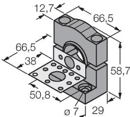
équerre de montage, PBT noir, avec plaque de montage, acier inoxydable, pour les formats à filetage 18mm, QM42/QMT42
