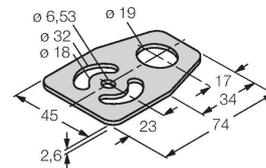
plaque de montage, acier inoxydable, pour les détecteurs à filetage 18mm
