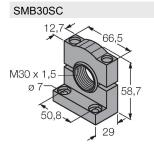
bride de fixation, noir PBT, pour les détecteurs à filetage 30 mm, orientable
