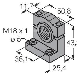
bride de fixation, noir PBT, pour les détecteurs à filetage 18 mm, orientable
