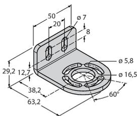
équerre de montage, noir, acier, pour EZ-ARRAY et EZ-SCREEN standard et en cascade 14 & 30 mm
