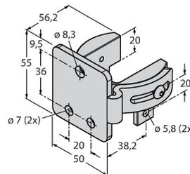
équerre de montage, noir, acier, pour EZ-ARRAY et EZ-SCREEN standard et en cascade 14 & 30 mm
