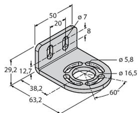
équerre de montage, noir, acier, pour EZ-ARRAY et EZ-SCREEN standard et en cascade 14 & 30 mm
