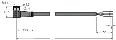
Câble de raccordement, connecteur femelle M8, coudé, 4 broches, longueur de câble : 2 m, matériau de la gaine : PVC, noir ; homologation cULus
