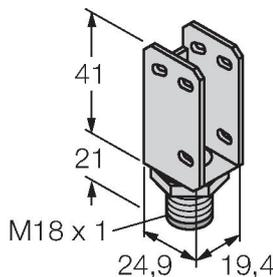
équerre de montage, acier inoxydable, pour filetage 18 mm
