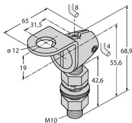
équerre de montage, acier inoxydable, pour format M12, filetage M10 x 1,5
