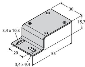
équerre de montage, acier inoxydable, montage horizontal, pour le format Q20
