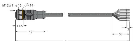
Câble de raccordement, connecteur femelle M12, droit, 8 broches, longueur de câble : 2 m, matériau de la gaine : PVC, noir ; homologation cULus
