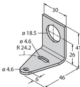
bride de fixation, coudée, acier inoxydable, pour les détecteurs à filetage de 18 mm
