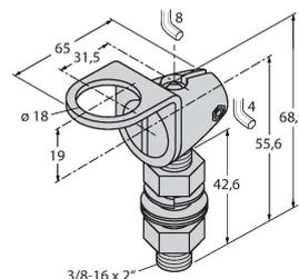
équerre de montage, matériau VA 1.4401, pour filetage 18 mm, filetage M10 x 1,5
