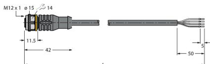
Câble de raccordement, connecteur femelle M12, droit, 4 broches, longueur de câble : 2 m, matériau de la gaine : PVC, noir ; homologation cULus
