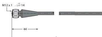
Câble de raccordement, connecteur femelle M12, droit, 5 broches, écrou de montage en acier, longueur de câble : 2 m, matériau de la gaine : TPE, gris ; plage de température : -40...+105 °C
