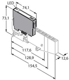
4 entrées digitales suivant EN 60947-5-6. Pour les détecteurs NAMUR, des contacts hors tension ou des détecteurs DC 2 fils uprox+.
