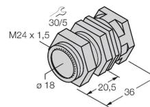
bride de fixation pour montage rapide avec butée fixe; matériau: Laiton chromé. Filetage externe M24 x 1,5. Conseil: La distance de commutation des capteurs de proximité peut être modifiée par l'utilisation de brides de fixation pour montage rapide.
