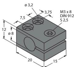
Bride de fixation pour détecteurs à tube fileté ; matériau du bloc de montage : aluminium, anodisé
