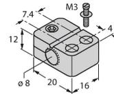
Bride de fixation pour détecteurs à tube fileté, avec butée fixe ; matériau : PA6
