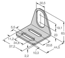
Équerre de fixation pour détecteurs à tube fileté ; matériau : acier inoxydable A2 1.4301 (AISI 304)
