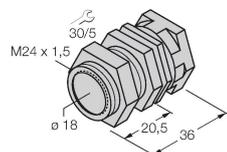
bride de fixation pour montage rapide avec butée fixe; matériau: Laiton chromé. Filetage externe M24 x 1,5. Conseil: La distance de commutation des capteurs de proximité peut être modifiée par l'utilisation de brides de fixation pour montage rapide.
