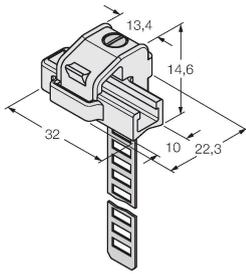
Pièce de serrage pour le montage de détecteurs de champs magnétiques sur vérins cylindriques ; diamètre du vérin : 8...25 mm ; matériau : PA 6I/6T / argentan ; classification d'incendie suivant UL94 - V2
