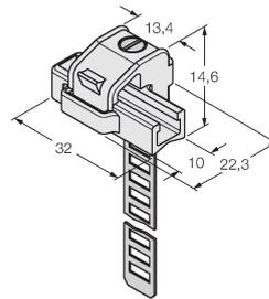
Pièce de serrage pour le montage de détecteurs de champs magnétiques sur vérins cylindriques ; diamètre du vérin : 130...250 mm ; matériau : PA 6I/6T / argentan ; classification d'incendie suivant UL94 - V2
