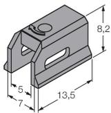
Pièce de serrage pour le montage de détecteurs de champs magnétiques sur des vérins à rainure en queue d'aronde ; largeur de rainure : 7 mm ; matériau : PPS
