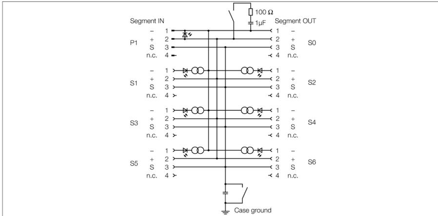
Le répartiteur à six canaux du type JBBS-49SC-E613/3G est conçu pour le FOUNDATION™ fieldbus.
