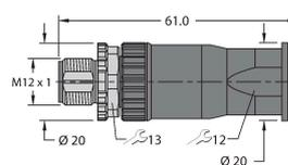
Connecteur mâle confectionnable, M12 x 1, droit, 5 pôles, raccordement par borne à vis, diamètre de ligne 4,0 à 8,0 mm, section conducteur/section raccordable 0,25 à 1,5 mm<sup>2</sup>, boîtier plastique, vis de montage métallique
