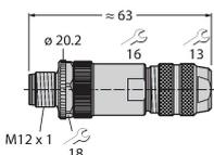
Connecteur mâle confectionnable, M12 x 1, droit, 8 pôles, raccordement par borne à vis, diamètre de ligne 6.0 à 8.0 mm, section conducteur/section raccordable 0,14 à 0.50 mm<sup>2</sup>, boîtier métallique, écrou de montage métallique, peut être blindé, e.a. pour Ethernet
