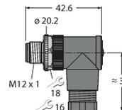
Connecteur mâle confectionnable, M12 × 1, coudé, 8 pôles, raccordement par borne à vis, diamètre de ligne 6,0 à 8,0 mm, section conducteur/section raccordable 0,14 à 0,50 mm<sup>2</sup>, boîtier plastique, vis de montage métallique
