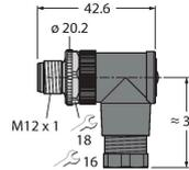
Connecteur mâle confectionnable, M12 × 1, coudé, 12 pôles, contact à braser, diamètre de ligne 6,0 à 8,0 mm, section conducteur/section raccordable 0,14 à 0,25 mm<sup>2</sup>, boîtier plastique, vis de montage métallique
