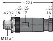
Connecteur mâle confectionnable, M12 × 1, droit, 12 pôles, contact à braser, diamètre de ligne 6,0 à 8,0 mm, section conducteur/section raccordable 0,14 à 0,25 mm<sup>2</sup>, boîtier plastique, vis de montage métallique
