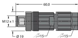
Connecteur mâle confectionnable, M12 x 1, droit, 5 pôles, raccordement Push-In, diamètre de ligne 4,0 à 8,0 mm, section conducteur/section raccordable 0,14 à 0,75 mm<sup>2</sup>, boîtier plastique, vis de montage métallique
