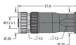
Connecteur femelle confectionnable, M12 x 1, droit, 5 pôles, raccordement par borne à vis, diamètre de ligne 4.0 à 8.0 mm, section conducteur/section raccordable 0,25 à 1.5 mm<sup>2</sup>, boîtier plastique, écrou de montage métallique
