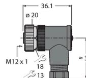
Connecteur femelle confectionnable, M12 x 1, coudé, 5 pôles, raccordement par borne à vis, diamètre de ligne 4.0 à 6.0 mm, section conducteur/section raccordable 0,25 à 0.75 mm<sup>2</sup>, boîtier plastique, écrou de montage métallique
