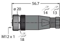
Connecteur femelle confectionnable, M12 x 1, droit, 5 pôles, raccordement par borne à vis, diamètre de ligne 4.0 à 6.0 mm, section conducteur/section raccordable 0,25 à 0.75 mm<sup>2</sup>, boîtier plastique, écrou de montage métallique
