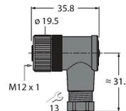
Connecteur femelle confectionnable, M12 x 1, coudé, 5 pôles, raccordement par borne à vis, diamètre de ligne 4.0 à 6.0 mm, section conducteur/section raccordable 0,14 à 0.75 mm<sup>2</sup>, boîtier plastique, écrou de montage métallique
