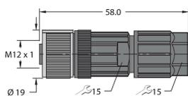
Connecteur femelle confectionnable, M12 x 1, droit, 5 pôles, raccordement Push-In, diamètre de ligne 4,0 à 8,0 mm, section conducteur/section raccordable 0,14 à 0,75 mm<sup>2</sup>, boîtier plastique, écrou de montage métallique
