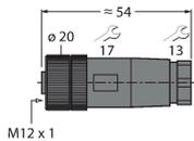
Connecteur femelle confectionnable, M12 x 1, droit, 5 pôles, raccordement par borne à vis, diamètre de ligne 4.0 à 6.0 mm, section conducteur/section raccordable 0,14 à 0.75 mm<sup>2</sup>, boîtier plastique, écrou de montage plastique
