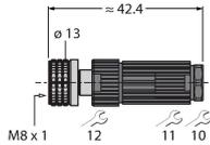
Connecteur femelle confectionnable, M8 x 1, droit, 3 pôles, technique de pénétration, diamètre de ligne 4.0 à 5.0 mm, section conducteur/section raccordable 0,14 à 0,34 mm<sup>2</sup>, boîtier plastique, écrou de montage métallique
