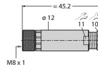
Konfektionierbare Kupplung, M8 x 1, gerade, 4-polig, Schraubklemmanschluss, Leitungsdurchlass 3.5 bis 5.0 mm, Adernquerschnitt/ Klemmvermögen 0.14 bis 0.50 mm<sup>2</sup>, Kunststoffgehäuse, Metallüberwurfmutter
