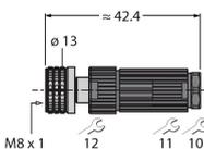
Connecteur femelle confectionnable, M8 x 1, droit, 4 pôles, technique de pénétration, diamètre de ligne 4.0 à 5.0 mm, section conducteur/section raccordable 0,14 à 0,34 mm<sup>2</sup>, boîtier plastique, écrou de montage métallique
