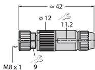
Connecteur femelle confectionnable, M8 x 1, droit, 4 pôles, raccordement par borne guillotine, diamètre de ligne 2.5 à 5.1 mm, section conducteur/section raccordable 0,14 à 0,34 mm<sup>2</sup>, boîtier plastique, écrou de montage métallique
