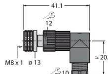
Connecteur femelle confectionnable, M8 x 1, coudé, 4 pôles, technique de pénétration, diamètre de ligne 4.0 à 5.0 mm, section conducteur/section raccordable 0,14 à 0,34 mm<sup>2</sup>, boîtier plastique, écrou de montage métallique
