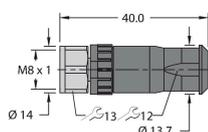
Connecteur femelle confectionnable, M8 x 1, droit, 4 pôles, raccordement par borne à vis, diamètre de ligne 4.0 à 5.5 mm, section conducteur/section raccordable 0,14 à 0,5 mm<sup>2</sup>, boîtier plastique, écrou de montage métallique
