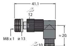
Connecteur femelle confectionnable, M8 x 1, coudé, 4 pôles, technique de pénétration, diamètre de ligne 4.0 à 5.0 mm, section conducteur/section raccordable 0,14 à 0,34 mm<sup>2</sup>, boîtier plastique, écrou de montage métallique
