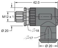
Connecteur mâle confectionnable, M12 x 1, coudé, 5 pôles, raccordement par borne à vis, diamètre de ligne 4.0 à 8.0 mm, section conducteur/section raccordable 00:25 à 1.5 mm<sup>2</sup>, boîtier plastique, vis de montage métallique
