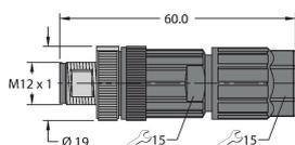
Connecteur mâle confectionnable, M12 × 1, droit, 5 pôles, raccordement Push-In, diamètre de ligne 4,0 à 8,0 mm, section conducteur/section raccordable 0,14 à 0,75 mm<sup>2</sup>, boîtier plastique, vis de montage métallique
