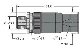
Connecteur mâle confectionnable, M12 × 1, droit, 5 pôles, raccordement par borne à vis, diamètre de ligne 4,0 à 8,0 mm, section conducteur/section raccordable 0,25 à 1,5 mm<sup>2</sup>, boîtier plastique, vis de montage métallique
