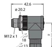
Connecteur mâle confectionnable, M12 × 1, coudé, 5 pôles, raccordement par borne à vis, diamètre de ligne 4,0 à 6,0 mm, section conducteur/section raccordable 0,14 à 0,75 mm<sup>2</sup>, boîtier plastique, vis de montage métallique
