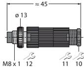
Connecteur mâle confectionnable, M8 x 1, droit, 4 pôles, technique de pénétration, diamètre de ligne 4.0 à 5.0 mm, section conducteur/section raccordable 0,14 à 0,34 mm<sup>2</sup>, boîtier plastique, écrou de montage métallique
