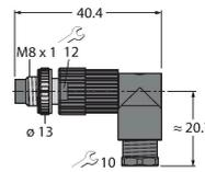
Connecteur mâle confectionnable, M8 x 1, coudé, 4 pôles, technique de pénétration, diamètre de ligne 4.0 à 5.0 mm, section conducteur/section raccordable 0,14 à 0,34 mm<sup>2</sup>, boîtier plastique, écrou de montage métallique
