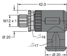
Connecteur mâle confectionnable, M12 x 1, coudé, 4 pôles, raccordement par borne à vis, diamètre de ligne 4.0 à 8.0 mm, section conducteur/section raccordable 0.25 à 1.5 mm<sup>2</sup>, boîtier plastique, vis de montage métallique
